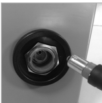
(4) LAMP 교체 후 분리 역순으로 조립 (Assembling in reverse order of separation after LAMP replacement.)
